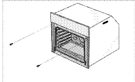
Fixați cuptorul folosind cele 2 șuruburi, conform ilustrației.
