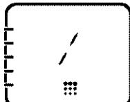
Această funcție permite curățarea automată a cuptorului la temperatură înaltă. Este recomandată pentru cuptoare ușor murdare. Pentru a utiliza această funcție, citiți descrierea din secțiunea Curățare. Vezi *Curățare automată pirolitică, pagina 28.*
