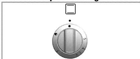
Cuptorul cu gaz poate fi utilizat prin intermediul butonului acestuia. În poziția Oprit (sus), alimentarea cu gaz este oprită.
