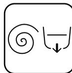
Utilizați pentru o centrifugare suplimentară a hainelor dumneavoastră sau evacuarea apei din interiorul produsului.
